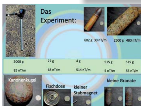
Abb. 12. Experimente zur remanenten Magnetisierung verschiedener Probekörper mit Angaben zum jeweiligen Gewicht und zu den mit dem Magnetometer ermittelten Messwerten für einen in allen Fällen gleichen Abstand.
