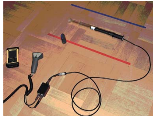
Abb. 4. Der Versuchsaufbau mit einem EBINGER-Dreiachsmagnetometer.
